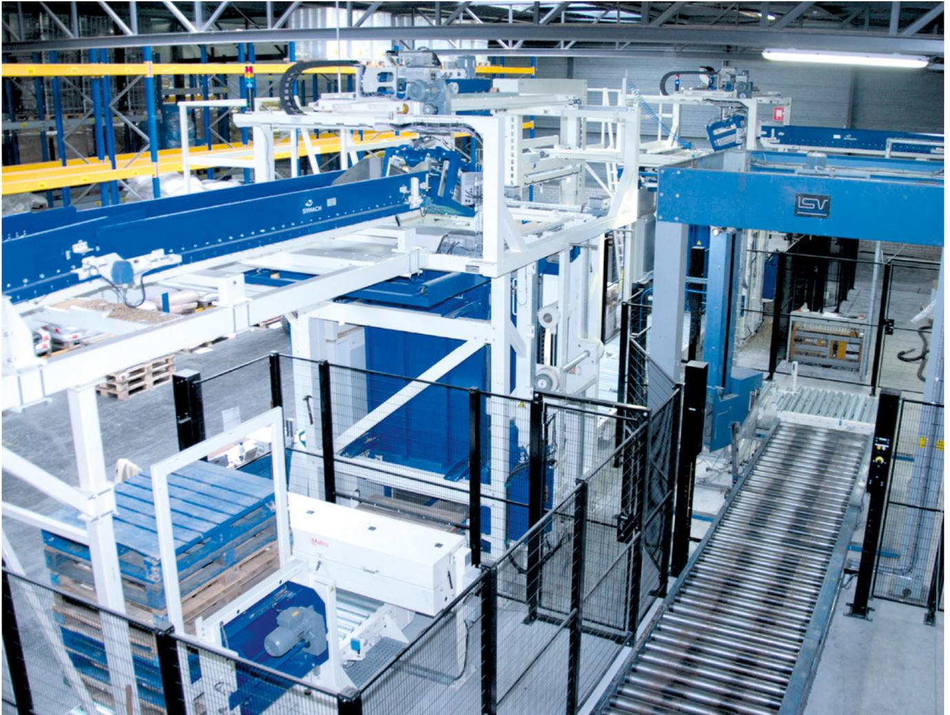
Palettiermaschine mit dezentral geregelten Asynchronantriebssystemen
