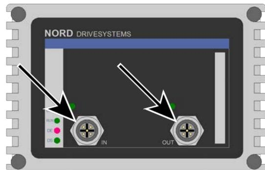
Der Anschluss der anderen Signal- und Steuerleitungen erfolgt über die Bus-Anschlusseinheit **SK TI4-TU-BUS(-C)**.
