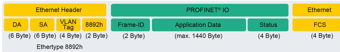
Abbildung 7: PROFINET IO-Telegramm (Kommunikation innerhalb eines Subnetzes)
