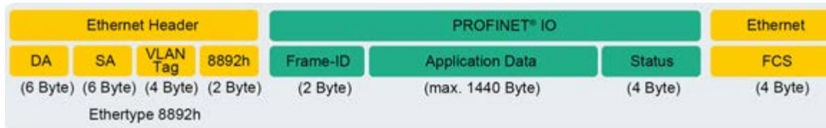
Abbildung 6: PROFINET IO-Telegramm (Kommunikation innerhalb eines Subnetzes)
