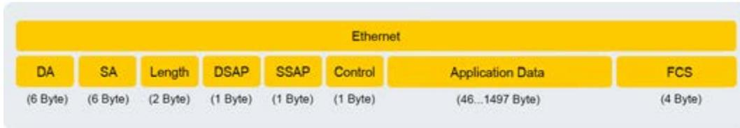
Abbildung 5: Ethernet-Telegramm (Mindeststrahlenlänge 64 Byte)
