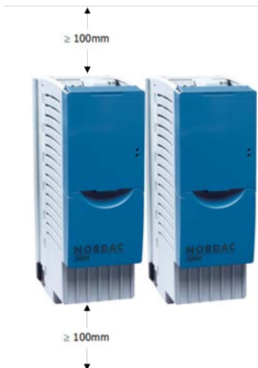
Figura 1: Distâncias de montagem SK 5xxE
