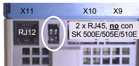
Figura 11: Parte superior del equipo con conector RJ12-RJ12
