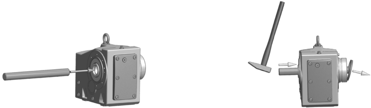
그림 5: 출고 시 설치된 잠금 캡 제거 방법
