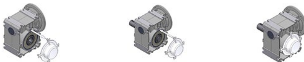
Obr. 15: Demontáž a montáž krycího víka
