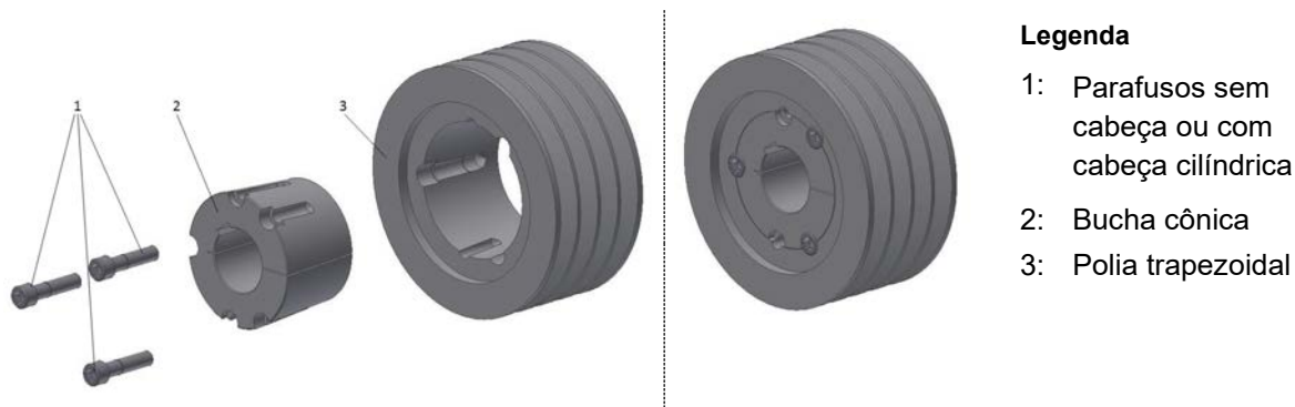
Figura 21: Polia trapezoidal (desmontada/montada)
