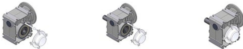
Obrázok 14: Demontáž a montáž krycieho veka
