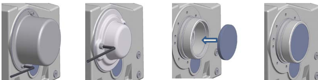
Obrázok 13: Montáž krytu voľba SH, voľba H a voľba H66
