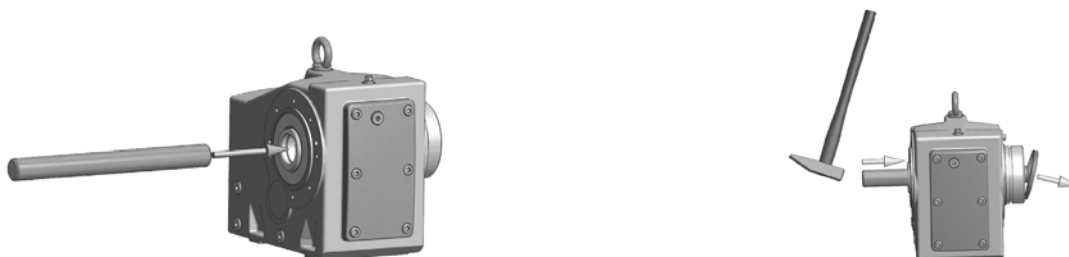
Obr. 5: Demontáž uzavíracího krytu namontovaného z výroby
