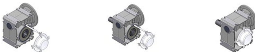
Obr. 14: Demontáž a montáž krycího víka
