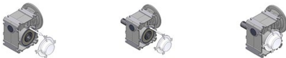
Illustration 14: Afmontering og montering af afdækningshætter
