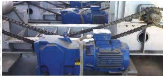
Motorreductores de engranaje cónico para lechos de enfriamiento – mesas de alimentación mediante cadenas
